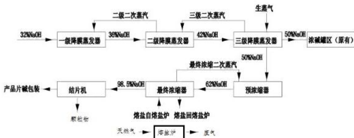
图 4.1-2 烧碱生产工艺及产排污环节（浓片碱工序）
